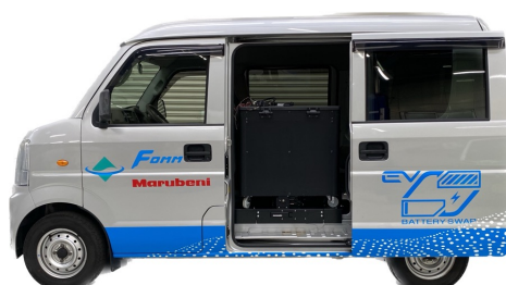
バッテリーコンテナ搭載タイプ
